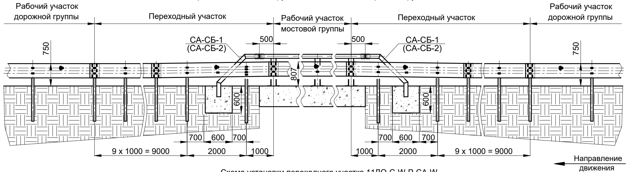
Схема установки переходного участка 11ДО-С-W-P-CA-W для ограждений мостовой группы высотой 1,1 м и дорожной группы высотой 0,75 м
